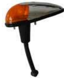
0615 Voorpinklicht, links of rechts, met oranje glas Blinkleuchte, vorn, Käfer, links oder rechts, Glas orange • Typ(e) 1 08/61-10/63
