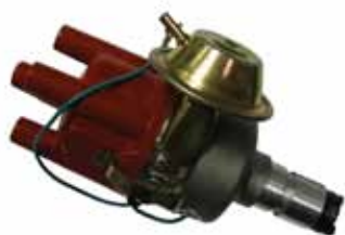
1998 Distributeur avec capsule à dépression Distributor with vacuum
