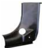
0886-101 Renfort de montant B pour cabriolet, droite B-pillar reinforcement, right, convertible • Type 1
