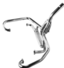
1020 Echappement Bobcat, 1 1/2" (Ø 38 mm), à peindre Bobcat exhaust, 1 1/2" (Ø 38 mm), bare
