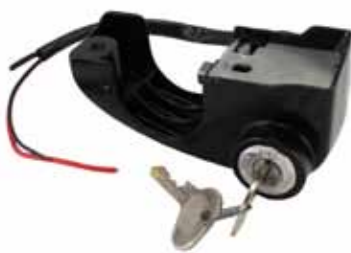
0655-1 Antivol et serrure de contact, pour montage sous la colonne de direction. Ignition/steering lock, for dashboard mounting. • Type 1/Type 14 08/56-07/67
